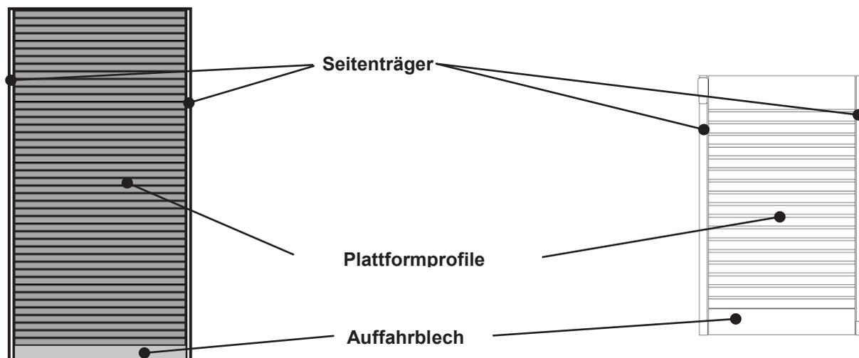
Quertraversen, Rollenlagerung sind nicht ersichtlich, da diese unterhalb der Plattformprofile montiert sind
