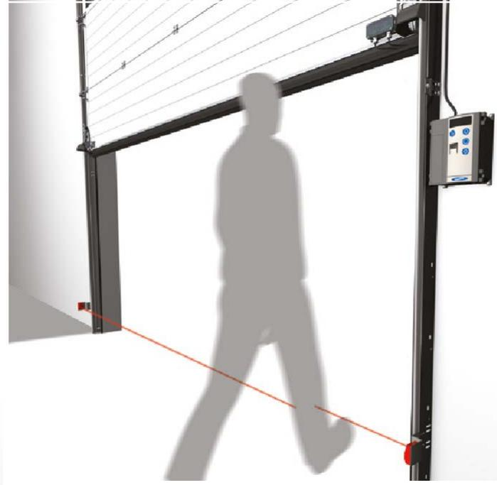
gegenüberliegenden Laufschiene befindet sich ein Reflektor oder Empfänger. Wenn der Strahl zwischen dem Sender und dem Reflektor / Empfänger unterbrochen wird, erhält der Antrieb ein Signal, das ihn stoppt und die Bewegung umkehrt. Die Version mit Reflektor ist störanfällig bei Staub und Feuchtigkeit, bei der Version mit Empfänger ist das kein Problem.
